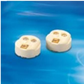
Keramikfassung G4, Anslusselement für Sockel GZ4, Schraubbefestigung, Buchsenklemme für Leitungsquerschnitte 0,75-1,5 mm<sup>2</sup>
