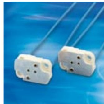
Keramikfassung G5,3 Anslusselement für Sockel GX5,3, 140 mm Teflonleitung, Schraubbefestigung
