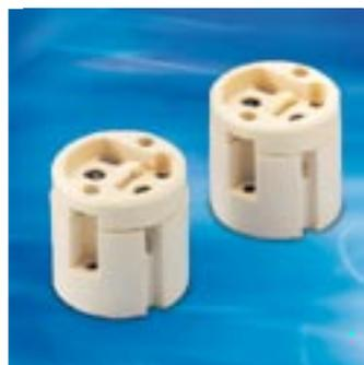
teilumhüllte Keramikfassung für Sockel G22, zur Verwendung mit Halogen-Glühlampen, Befestigung: Schrauben M5
