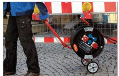
Trommelkörper in Fahrtrichtung
