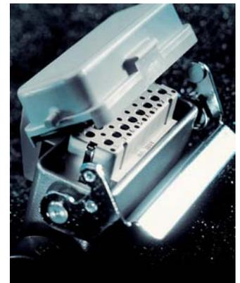
Die Schraubverriegelung (zwei M 6 Schrauben) wird mit einem Schraubendreher befestigt. Durch die Betätigung mit Werkzeugen wird ein Öffnen durch Unbefugte erschwert. Hier stehen für den Schaltschrank sowie die Tüllengehäuse Schutzdeckel zur Verfügung.
