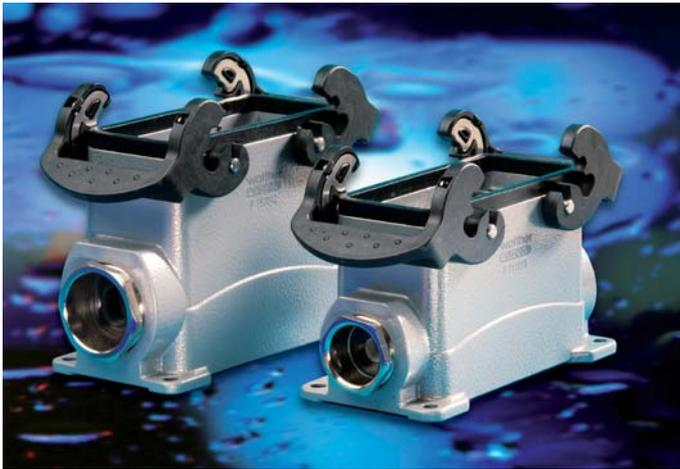
Dem Anwender steht eine Vielzahl unterschiedlicher Gehäusehöhen zur Verfügung. Einerseits, um bei großen Leiterquerschnitten einen genügend großen Anschlussraum zu bieten, andererseits, damit über die größere Oberfläche des Anschlussraums die entstehende Verlustwärme abgeführt wird.
