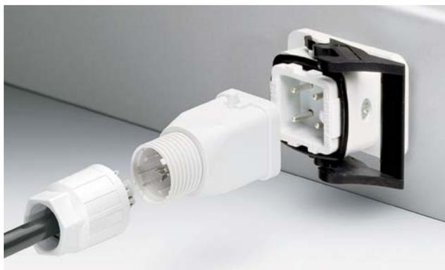
Es muss nur ein Teil - die Überwurfmutter - auf die Leitung geschoben werden, denn der Spleißring, die Dichtung und die Zugentlastungskrone sind mit der Überwurfmutter verbunden.
