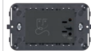
09290.CM 230 V~ 50/60 Hz, mit isolierten Trafo 20 VA, Ausgänge 230 V~ und 120 V~ - 3 Module. Tiefe: 42 mm
