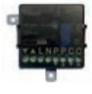
03996 Elektronisches Relaismodul Quid für Rollläden mit Lamellenausrichtung mit Relaisausgängen für Motor cosφ 0,6 2 A 220-240 V~ 50/60 Hz, Positionsspeicherung, Installation in Abzweigoder Einsatzdosen
