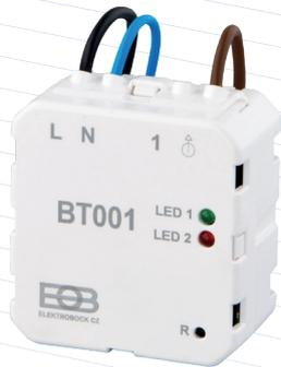
Der SIKU BT001 ist ein drahtloser Empfänger für BT710 und BT010, schaltet aufgrund der erfassten Daten vom Funk-Raumthermostat die Heizungsanlage aus und ein. Nur für Innenräume geeignet. BT001 nicht in der Nähe von Kraftfeldern anbringen.
