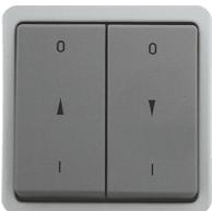
Jalousieschalter 10 A, 250 V~, (Wippen-Ausführung), **Schalter** für Doppelwippe, 1-polig, mit PE-Klemme, mit elektrischer Verriegelung, Kontaktunterbrechung beim Betätigen beider Wippen
