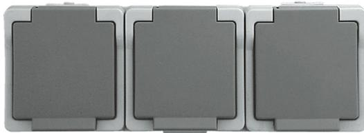
Schuko-Steckdose, 16 A, 250 V~, 2-polig + PE, waagrecht, mit Klappdeckel, vorverdrahtet, schraubenlose Steckklemme, aus bruchsi-
