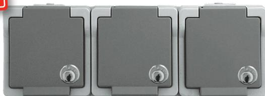
Schuko-Steckdose, 16 A, 250 V~, 2-polig + PE, waagrecht, mit Klappdeckel, abschließbar, vorverdrahtet, schraubenlose Steckklem-
