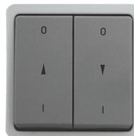
Jalousietaster 10 A, 250 V~, (Wippen-Ausführung), **Taster** für Doppelwippe, 1-polig, mit PE-Klemme, mit elektrischer Verriegelung, Kontaktunterbrechung beim Betätigen beider Wippen
