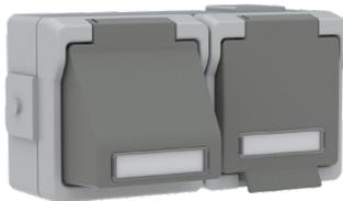
Keystone-Dose + Steckdose, 2-fach waagrecht, **inkl. einem** Keystone Einsatz Cat. 6A, **25 Gbit/s**, geschirmt, RJ45, geeignet für PoE+ und **einer** Schuko-Steckdose, 16 A, 250 V~, 2-polig + PE, **inkl. Trennwand**, inkl. Klappdeckel, mit Beschriftungsfeld und Papierstreifen
