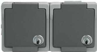
Schuko-Steckdose, 16 A, 250 V~, 2-polig + PE, waagrecht, mit Klappdeckel, abschließbar, vorverdrahtet, schraubenlose Steckklemme, aus bruchsicherem Thermo-
