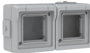
45er Dose, 2-fach, zur individuellen Bestückung mit 45er Modulen, ohne Klappdeckel, Einbaumaß 45er Modul L x B x T = 45 x 45 x 45,5mm
