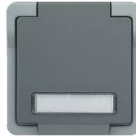
Schuko-Steckdose, 16 A, 250 V~, 2-polig + PE, mit Klappdeckel, mit Beschriftungsfeld und Papierstreifen, schraubenlose Steckklemme, aus bruchsicherem Thermoplast
