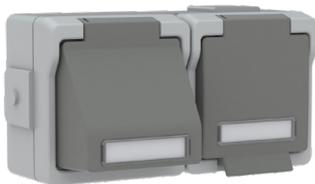
Keystone-Dose + Steckdose, 2-fach waagrecht, mit einer Schuko-Steckdose, 16 A, 250 V~, 2-polig + PE, inkl. **Trennwand**, zur individuellen Bestückung mit bis zu zwei Keystone-Elementen, inkl. Klappdeckel, mit Beschriftungsfeld und Papierstreifen
