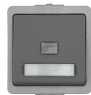
Taster, Schließer, 10A, 250V~, ohne Beleuchtungseinsatz, mit schraublosem Steckanschluss, mit Beschriftungsfeld und Papierstreifen, Linse klar
