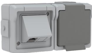
Keystone-Dose + Steckdose, 2-fach waagrecht, **inkl. einem** Keystone Einsatz Cat. 6A, **25 Gbit/s**, geschirmt, RJ45, geeignet für PoE+ und **einer** Schuko-Steckdose, 16 A, 250 V~, 2-polig + PE, **inkl. Trennwand**
