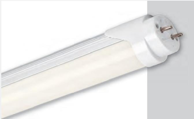
Hochwertige T8 LED-Röhre (26 mm) aus opalem Polycarbonat mit integriertem Kühlkörper aus Aluminium, für den direkten Betrieb an AC 230 V oder mittels im Lieferumfang enthaltenem LED-Starter als RETROFIT für Leuchten mit magnetischem Vorschaltgerät.
