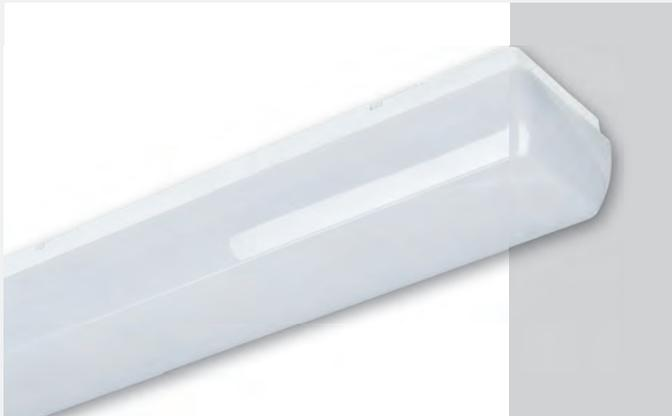
Weißer Grundkörper mit umlaufender Dichtung inklusive opaler Wanne mit integrierten Drehverschlüssen, aus schlagfestem und UV-stabilem Polycarbonat, Schutzart IP54.
