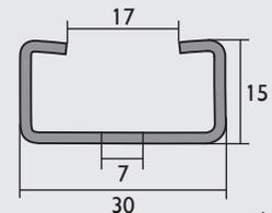
$$\text{maximale Durchbiegung} = \frac{L}{100}$$
