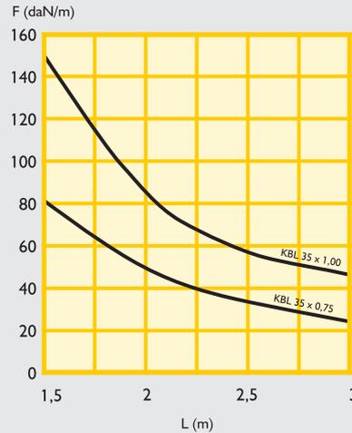
maximale Durchbiegung =  $\frac{L}{100}$
