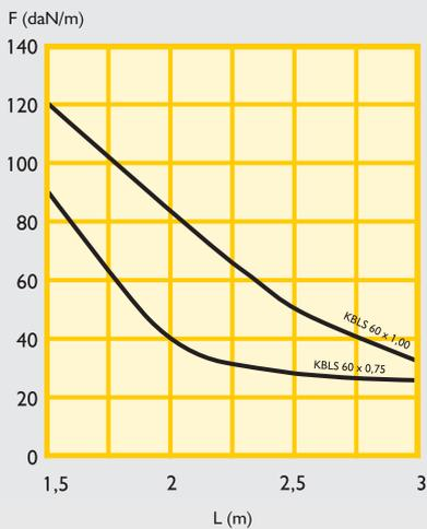
maximale Durchbiegung =  $\frac{L}{100}$
