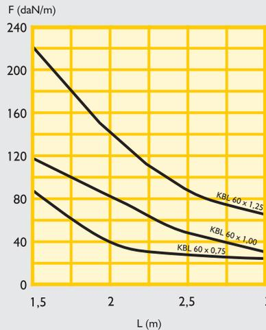
maximale Durchbiegung =  $\frac{L}{100}$
