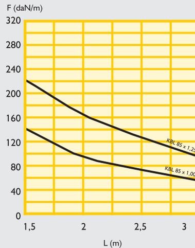
maximale Durchbiegung =  $\frac{L}{100}$
