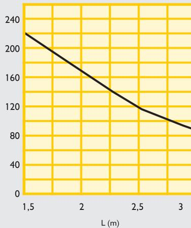
maximale Durchbiegung =  $\frac{L}{100}$
