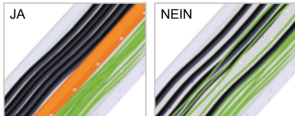
Zum Erhalt einer elektromagnetischen Verträglichkeit ist eine räumliche Trennung der Energie- und Datenkabel in einer Rinne notwendig.
