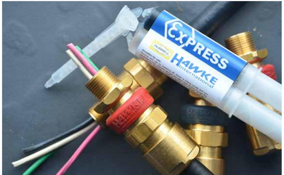
501/453/UNIVERSAL erwerben, die alle Anforderungen hinsichtlich einer Standard-Ex-Kabelverschraubung abdeckt. Durch den kurzfristig lieferbaren Umrüstsatz mit Knetmasse oder Flüssigharz erfüllt die 501/453/UNIVERSAL nach der minuten-schnellen Umrüstung auf die Type ICG653/UNIVERSAL auch alle Anforderungen an eine Ex d-Vergussmassen-Kabelverschraubung. Für die Kunden bedeutet dies beträchtliche Kosteneinsparungen durch schnelles Umrüsten im Feld und Flexibilität bei den Beständen“.
