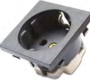
SCHUKO<br>nach DIN VDE 0620-1<br>250 V -   16 A<br>Leitungsanschluss bis 2,5mm <sup>2</sup><br>für Wandstärke 1,6mm             | 34               | ⊕            | 103201 ...       | ●        | ●       | ●            | 10/200 |
