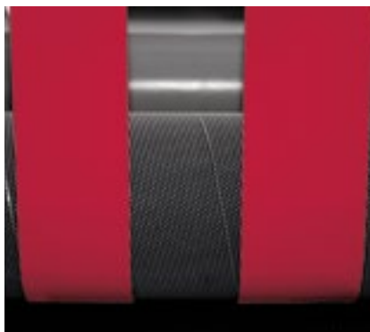
Anwendungsbeispiel: Coroplast 812 X (schwarz/anthrazit) als Walzenausrüstung beim Umrollen von Klebeband (rot)
