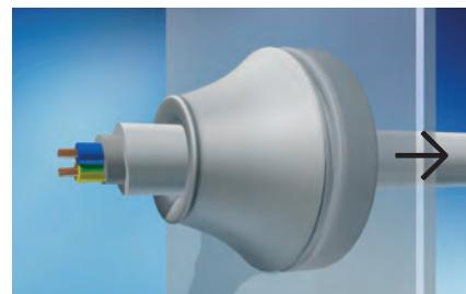
Die Dichtungsdurchführung sitzt fest, sobald das Kabel etwas nach hinten gezogen wird.
