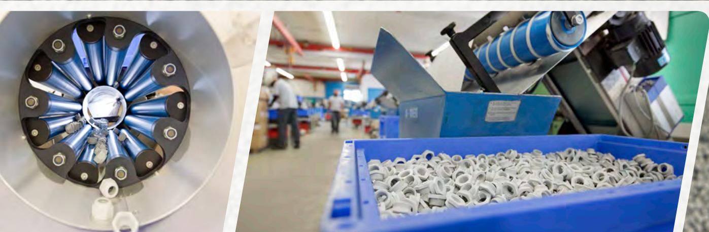
Jacob Kabelverschraubungen und Zubehörteile werden aus qualitativ hochwertigen Polyamiden gefertigt. Wir verarbeiten aber auch andere Kunststoffe wie zum Beispiel Polyethylen und Polypropylen.
