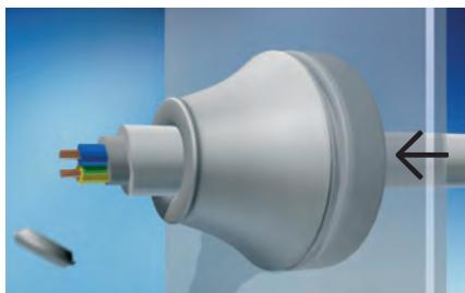
Führen Sie das Kabel durch die Dichtungsdurchführung.
