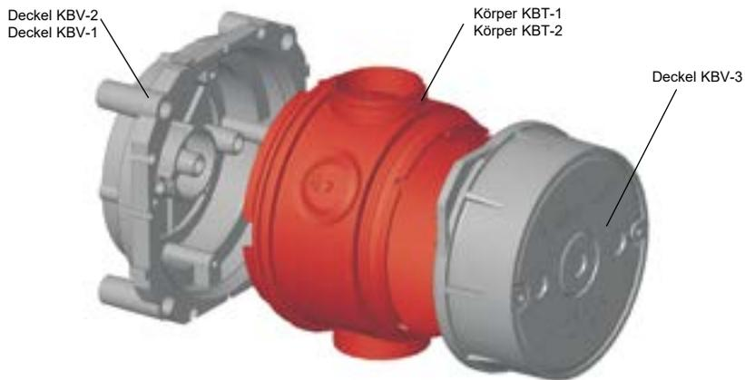
Der Deckel KBV 3 wird benötigt, wenn Elektrogeräte an beiden Seiten einer Zwischenwand montiert werden sollen, sowie zur Montage mit der Dose KBT-1 (oder KBT-2) und dem Deckel KBV-1 (oder KBV-2).
