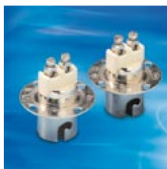
Messingfassung, für Halogen geeignet, Buchsenklemmen, Gehäuse vernickelt, massive, federnde Kontaktstifte, Befestigung: Flansch
