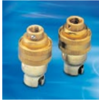
Messingfassung, für Halogen geeignet, Buchsenklemmen, Keramikeinbau, massive, federnde Kontaktstifte, Befestigung: Nippel M10x1
