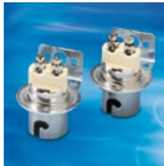
Messingfassung, für Halogen geeignet, Buchsenklemmen, Gehäuse vernickelt, massive, federnde Kontaktstifte, Einbaufassung mit Befestigungswinkel
